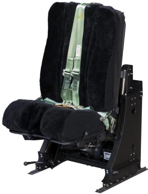
Projekt: Umwandlung eines originalen Chinook Hubschraubersitzes in einen G-Seat (ein G-Seat ist ein Pilotensitz mit eingebauten Aktuatoren, der die Flugbewegungen simuliert. Dabei muss der Sitz so aussehen und sich so anfühlen wie das Original und sich während der Flugsimulation bewegen können.)
